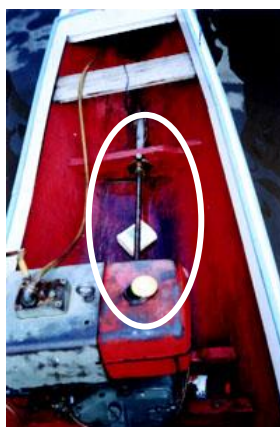
Figura 04 - O motor fixo no centro da embarcação com o eixo exposto em alta rotação, que se estende longitudinalmente do motor até a hélice, sem qualquer tipo de proteção.
