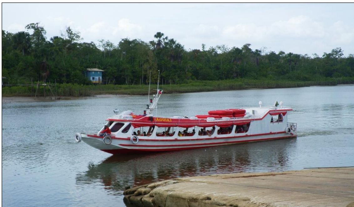
Figura 9 – Lancha construída em alumínio para transporte de passageiros.
